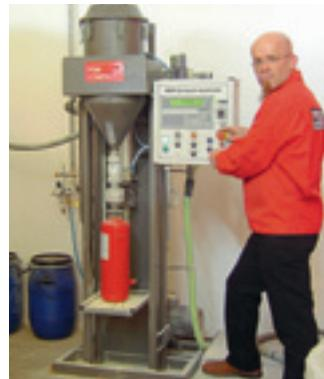
Neufüllung von Pulverfeuerlöschern mit unserer computer-gesteuerten Pulverfüllanlage
